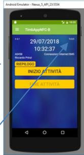
Nota: in alto a destra "Tr xx/yy" sono visualizzate rispettivamente le timbrature effettuate e quelle trasmesse
